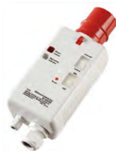
Motorschutzstecker mit Schwimmer- und Schütz- option, Drehfeldkontrolle und Phasenwender CEE 16 A 400 V
